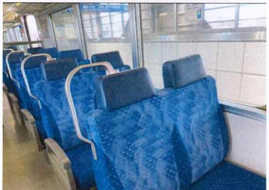
3000系は、車体の軽量化による消費電力の低減や、省メンテナンス化など環境にやさしい車両になっていて、車内は、西鉄では唯一のクロスシート。乗り心地もよく、西鉄でもかなり最先端な車両。
