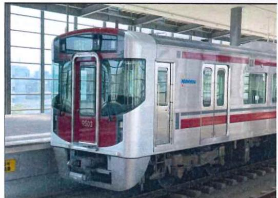
さらに、西鉄で一番新しい9000系は、前照灯、尾灯、車内照明をLEDにすることで、西鉄の5000系と比較して約50%も、省エネルギー化を図っている。
