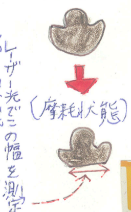
レーザー光でこの幅を測定し、電車線の残りの面積を割り出します。
