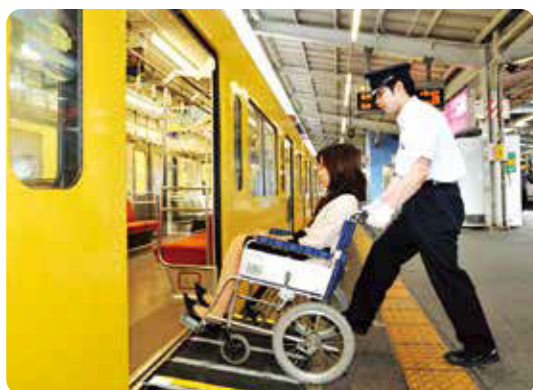
くるま の お 車いすでも乗り降りしやすいように、 でんしゃ 電車とホームのすき間や段差をなくす渡り板
