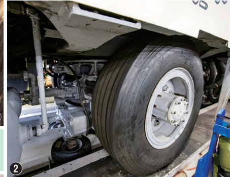
①ワンハンドルマスコンを装備した「こあら号」の運転台。②走行用のゴムタイヤは中にチューブが入った特殊なもの。③横に倒れた二つのタイヤでレール中央にある軌道を扶むようにして車両を誘導する。④住宅地の下を通るトンネルを抜け、坂を上る車両（中学校駅～井野駅間）。⑤顔認証やQRコード（※）が使える改札口（ユーカーが丘駅）。⑥「こあら4号」から「こあら12号」までは9台のバスが稼働している。
