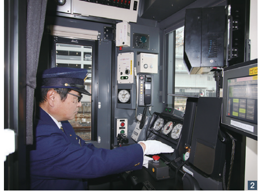
1 試験車両に積載した自動運転システム。2 赤色の緊急停止ボタンに手を添える係員。緊急時にはボタンを押す。 3 車両内で走行試験の様子を見守る関係者。4 自動運転の状況を確認するためのモニター画面。 5 走行試験が行われた和歌山港線の和歌山港駅。6 緑色ボタンが起動時に押下するボタンで、赤色のボタンが緊急停止ボタン。 7 走行試験に使われた信号機。
