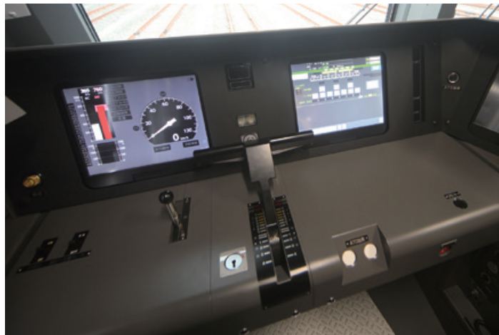
70000系運転台。車上データが表示される
