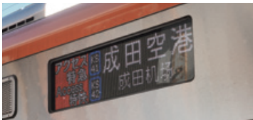
上/車体に表示した沿線の名所。写真は成田山新勝寺 左/座席の一部を折り畳み、スーツケースを置ける 下/大型の側面行先表示器は4カ国語、駅ナンバリング表示にも対応
