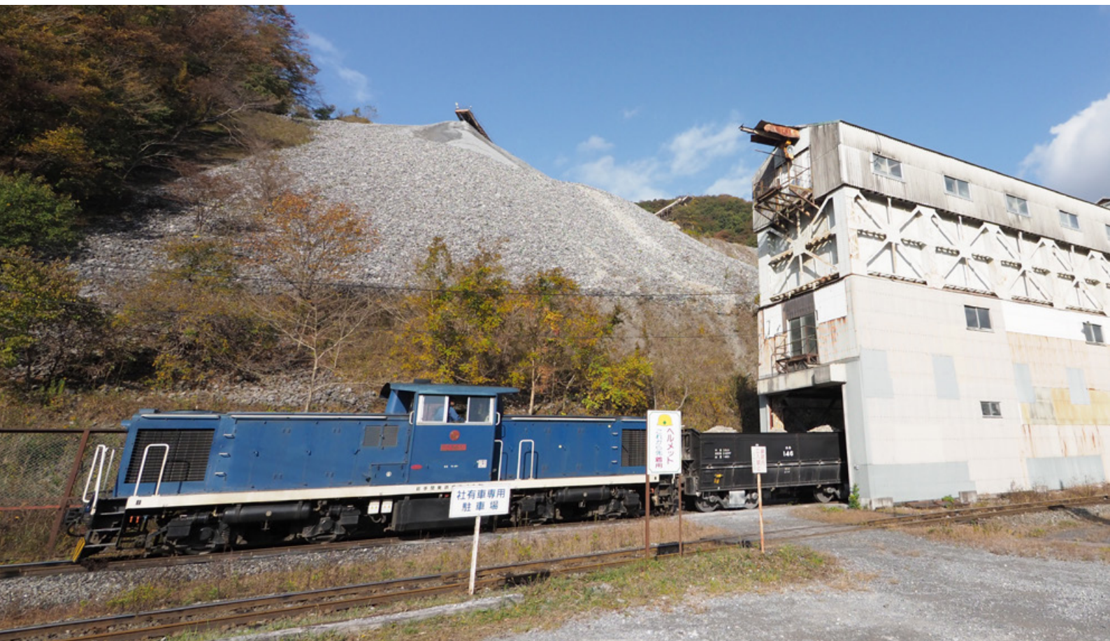
岩手石橋駅。石灰石の積込施設では一度に貨車6両分ずつ作業する
