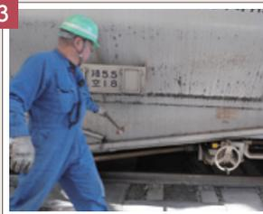
プラスチックハンマーでタンクの各部を叩いて音をチェック。音の変化でフライアッシュが全部出たかがわかるそうだ。全部排出されたことが確認できたら、貨車の排出口、ホース、ホームの受け口を閉じて終了。この間、約12分。
