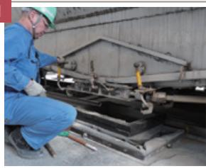
列車を移動させ、貨車の下にある排出口と、ホームに開いているフライアッシュの受け口とをピッタリと合わせる。見ていたら一発で合わせていた。職人技だ。貨車の排出口をホームの受け口に接続する。
