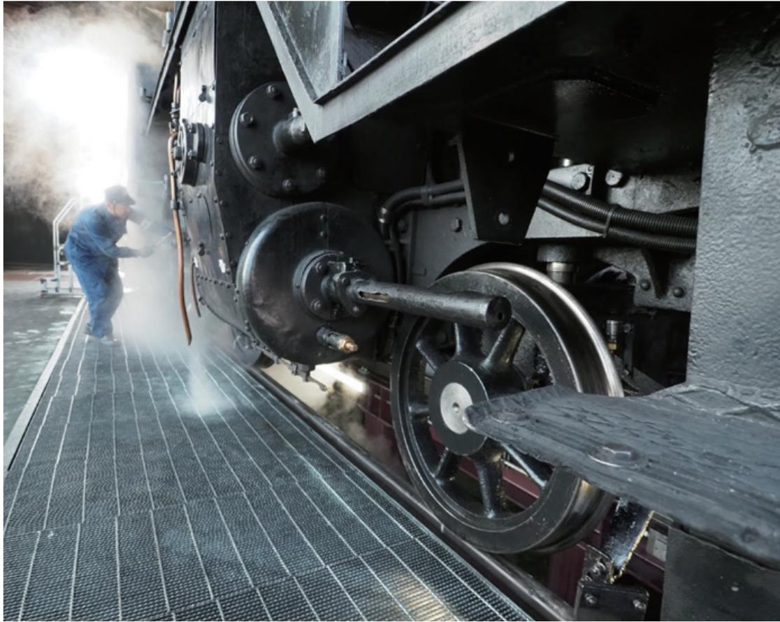
目を凝らし耳を研ぎ澄まして、打音検査を行う黒田機関士。前方で蒸気が噴き上がる
