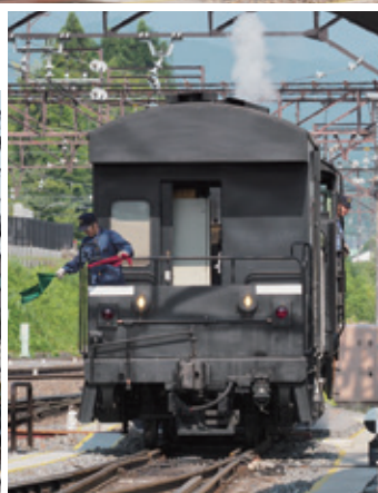
上／客車は14系3両で編成を組む。下／補機のDE10形も大樹のヘッドマークが付いている。右／ATS搭載の車掌車はSLの真後ろに連結
