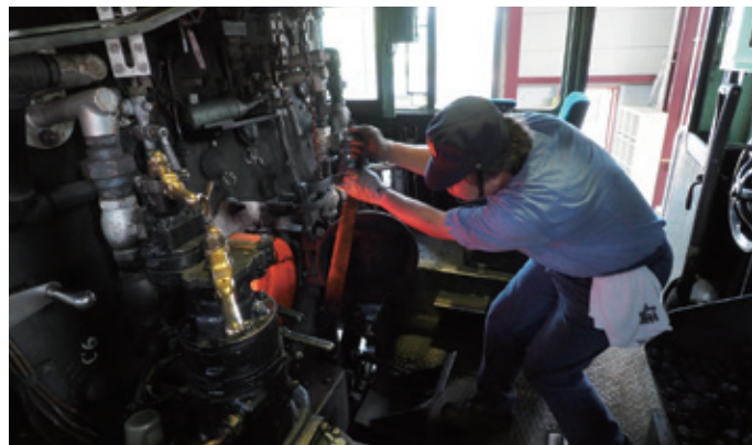
火室の中にたまった灰を捨てた後、投炭して火床を整える
