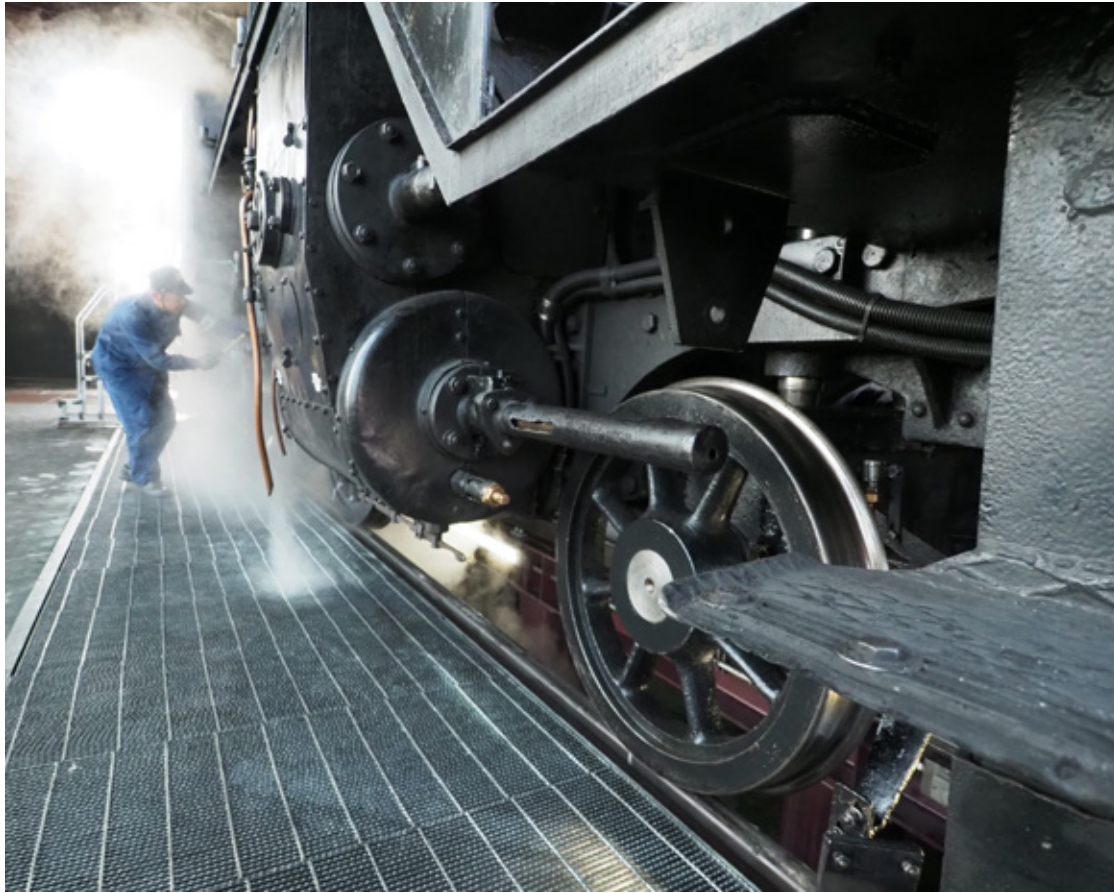
目を凝らし耳を研ぎ澄まして、打音検査を行う黒田機関士。前方で蒸気が噴き上がる
