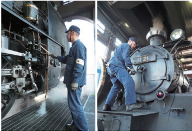
ハンマーでたたいて打音検査を行う
