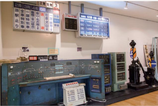
CTC制御盤。平成元年まで小牧駅に設置されていた。上に展示されている案内表示装置は、左が太田川駅、右が犬山駅に設置されていた。
