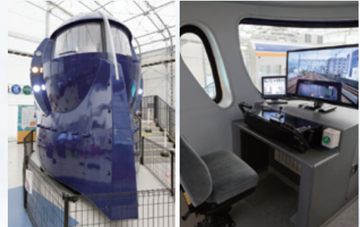
ラピートは実物大の模型。運転席には運転士シミュレーターが設置されている。
