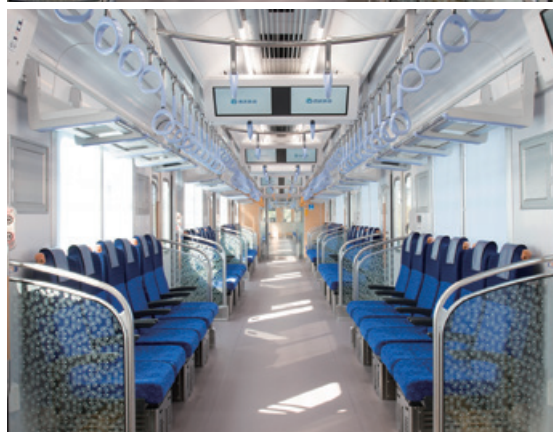
上／クロスシート状態の車内。天井には広告用デジタルサイネージを設置。下／ロングシート状態にした車内。
