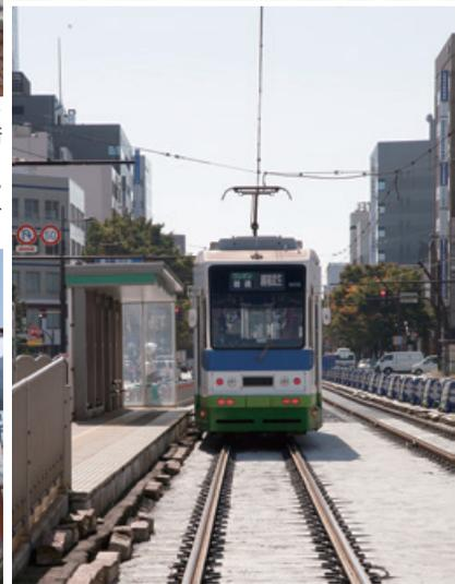
定時性を確保するため、軌道区間には右折車両分離方式信号を導入。併せて電停を拡幅する改良工事も進められた。
