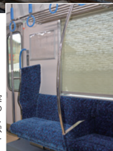
「安全・快適」な乗り心地を実現した車内空間。独特な形の大型袖仕切りを採用したほか、座席には立ち座りしやすい形状に工夫した「ちょい乗りシート」を試験的に採用
