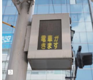
1 定時性確保のため、さまざまな交通施策がとられている。2 信号も電車の走行に配慮して制御される。3 電車接近表示器。4 電車ロケーションシステム。5 平成24年に現役を引退したドルトムント電車。6 昭和51年に西日本鉄道から移籍した3000形。7 ハノーバー市から広島市に寄贈されたハノーバー電車。
