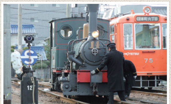
「坊っちゃん列車」は手押しで回る。実は、転車装置を内蔵しているため、手でも回せるとのこと。
