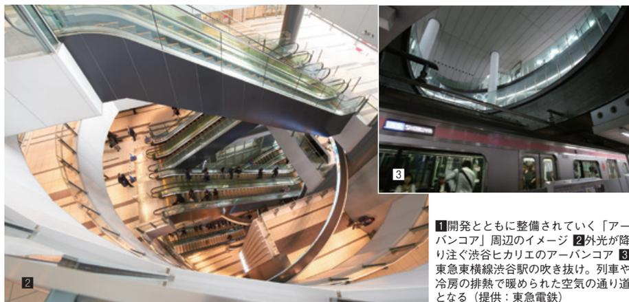
1開発とともに整備されていく「アーバンコア」周辺のイメージ 2外光が降り注ぐ渋谷ヒカリエのアーバンコア 3東急東横線渋谷駅の吹き抜け。列車や冷房の排熱で暖められた空気の通り道となる（提供：東急電鉄）
