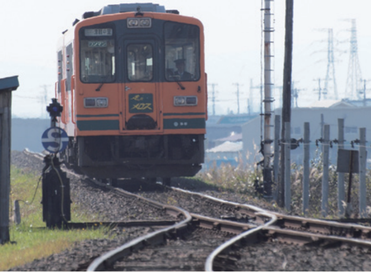
金木駅構内の腕木式信号機。国内の旅客路線で現在も使用しているのは津軽鉄道だけ（写真下）。また、自動閉塞を導入していない津軽鉄道では、列車交換駅で、運転士が輪状のタブレットキャリアと棒状のスタッフを交換する（写真上）。
