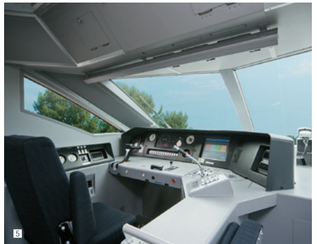
1 空港利用者の大型荷物を収納する荷物スペース 2 車内は端正できりっとした雰囲気を醸しつつも温かいくつろぎ感に満ちている 3 最高速度を示す高速進行信号と新型スカイライナー 4 客室前後のモニターは26インチの大型で見やすい 5 新型スカイライナー乗務員室の運転台。操作性と安全性が配慮されている
