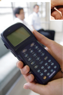
①瓦町、片原町、高松築港の主要3駅にはIC専用自動改札機を設置。 ②無人駅35駅を含む48駅には簡易自動改札機が設置されている。 ③チャージや入場記録書き込みができる携帯端末。
