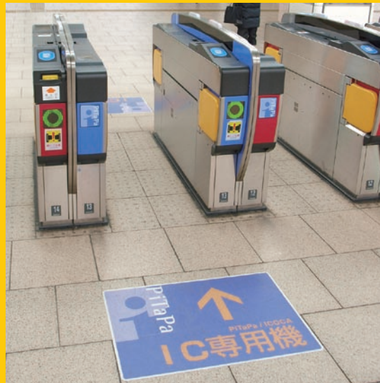
現在の非接触型ICカード自動改札機(近畿日本鉄道・大阪阿部野橋駅にて)。
