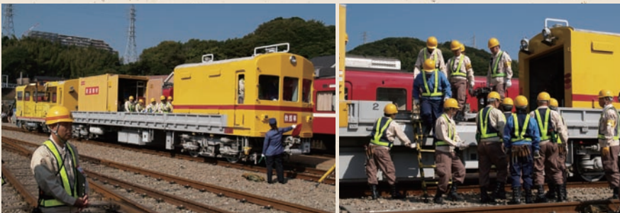
万が一の事故や災害発生時に備えて装備されている救援車。今回の訓練では、脱線復旧機材を搭載、現場に向かう。
