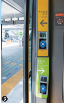
① 2面4線の平石停留場は快速列車が普通列車を追い抜くことも可能な構造となっている。②宇都宮駅東口停留場を出発すると半径25メートルの急カーブを曲がる。③交通系ICカードをタッチすることで、すべてのドアから乗り降りできる。④⑤現金で乗車する場合はホームで整理券を取り、運賃箱で支払う。⑥ライトラインを模したデザインが施された業務用の自動車。⑦平石停留場の近くに設けられた車両基地。現在、17編成が運用されている。
