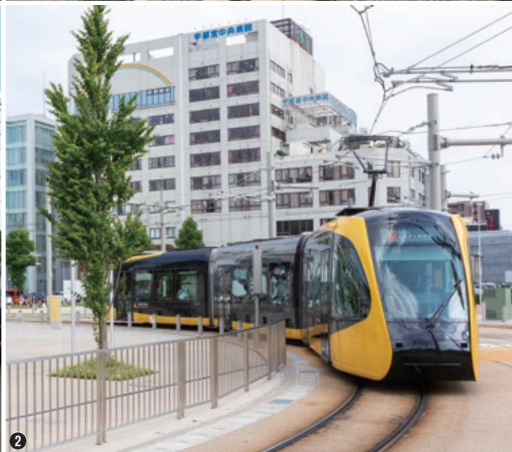
① 2面4線の平石停留場は快速列車が普通列車を追い抜くことも可能な構造となっている。②宇都宮駅東口停留場を出発すると半径25メートルの急カーブを曲がる。③交通系ICカードをタッチすることで、すべてのドアから乗り降りできる。④⑤現金で乗車する場合はホームで整理券を取り、運賃箱で支払う。⑥ライトラインを模したデザインが施された業務用の自動車。⑦平石停留場の近くに設けられた車両基地。現在、17編成が運用されている。
