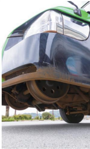
左/運転席左のスイッチを押すと、鉄道用の車輪が下されモードチェンジ。
