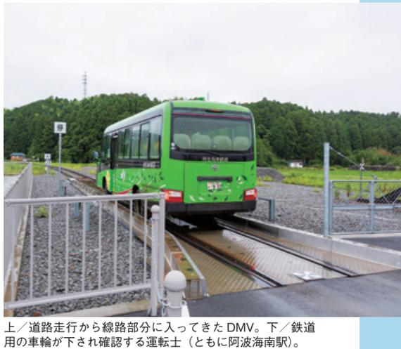
上/道路走行から線路部分に入ってきたDMV。下/鉄道用の車輪が下され確認する運転士(ともに阿波海南駅)。
