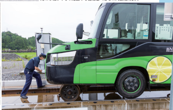
上／道路走行から線路部分に入ってきたDMV。下／鉄道用の車輪が下され確認する運転士（ともに阿波海南駅）。
