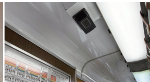
車内でトラブル発生の際、リアルタイムで映像と音声を確認できる防犯カメラ。
