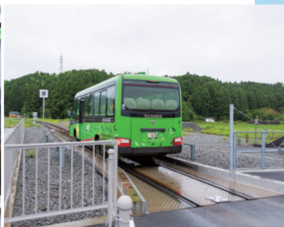
上／道路走行から線路部分に入ってきたDMV。下／鉄道用の車輪が下され確認する運転士（ともに阿波海南駅）。
