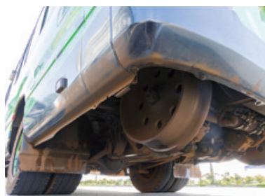
道路走行モードでは格納されている鉄道用の車輪（右が車両前部、上が車両後部）。
