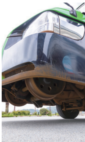
道路走行モードでは格納されている鉄道用の車輪（右が車両前部、上が車両後部）。
