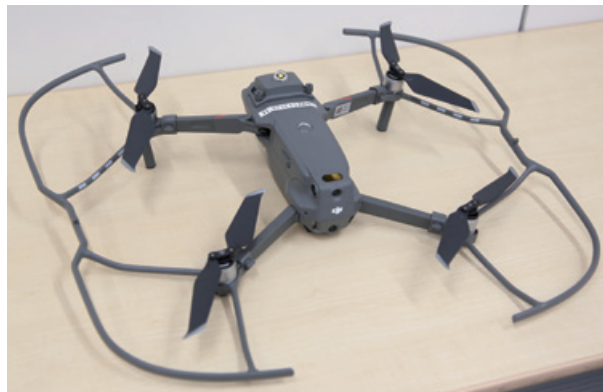
点検に使用されるドローン
