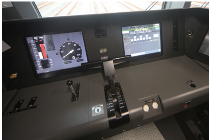
70000系運転台。車上データが表示される
