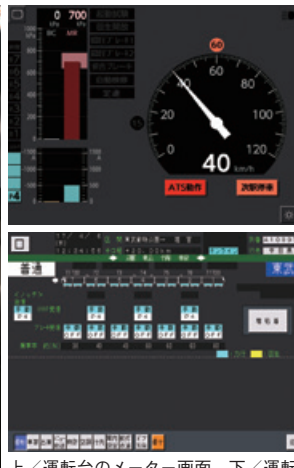
上/運転台のメーター画面 下/運転情報が表示されたモニター画面
