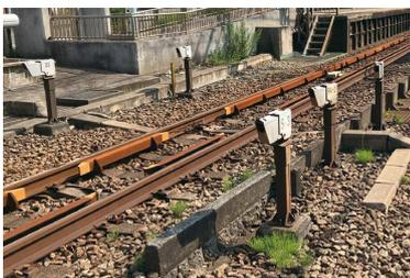
障害物検知装置(レーザー式)
