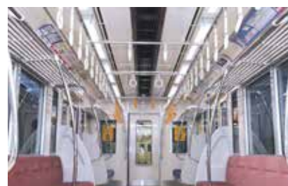
車内のLED照明
