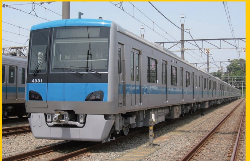
①小田急電鉄株式会社の新型通勤車両「4000形」。2007年9月より順次、東京メトロ千代田線への直通運転用車両として営業運転を開始する。 ②騒音・振動対策に関して、新しい技術を積極的に取り入れている小田急電鉄。防音車輪の装着率は100%に達している。
