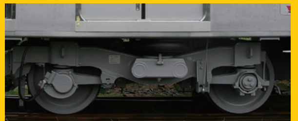
①小田急電鉄株式会社の新型通勤車両「4000形」。2007年9月より順次、東京メトロ千代田線への直通運転用車両として営業運転を開始する。 ②騒音・振動対策に関して、新しい技術を積極的に取り入れている小田急電鉄。防音車輪の装着率は100%に達している。
