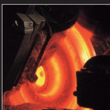
鍛造→圧延→整型→徐冷
