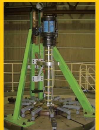
車輪に負荷を加え、強度をチェックする「車輪実体疲労試験機」。
