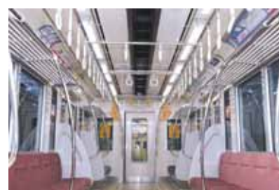
車内のLED照明
